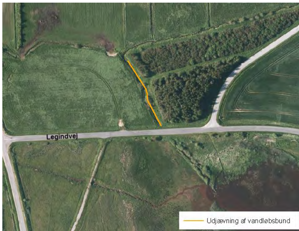
Figur 3-6 Overblik over projektforslag. Den orange linje angiver strækningen, hvor vandløbsbunden udjævnes og der skabes et jævnt fald.
